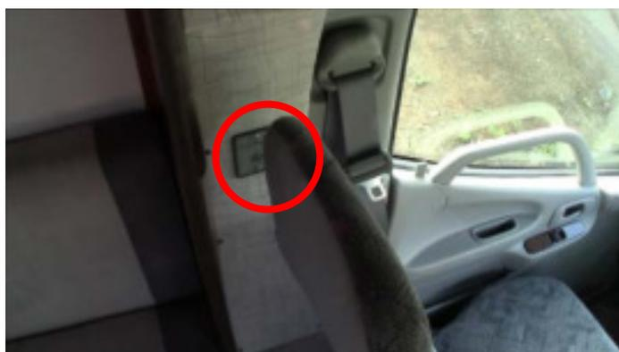
助手席の横にインバーターのスイッチがあります。テレビや電子レンジを使う際にスイッチを入れます。サブバッテリーの電気を100Vに変換する機械です。
