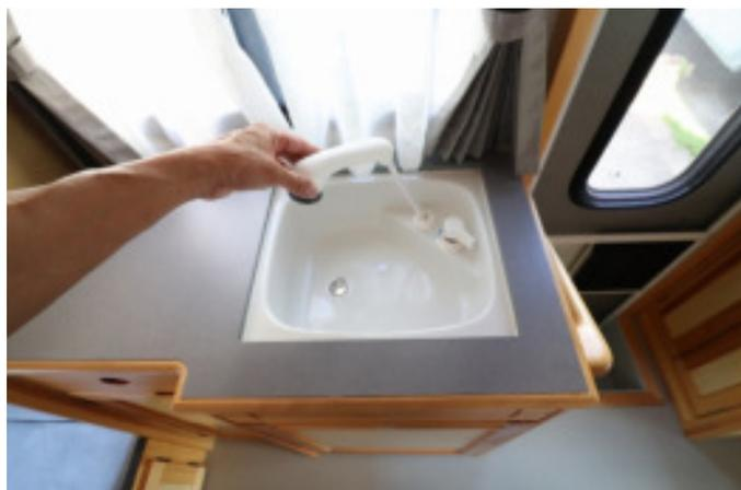
給水タンクに水を入れます。集中スイッチの水道を ON にしてください。蛇口は伸ばせばシャワーになります。
