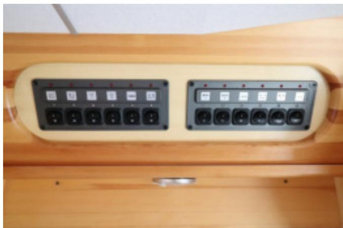
車内の照明、水道ポンプ、冷蔵庫などを使うときに ON 電気はサブバッテリーからとっています。使いすぎて空になってもメインバッテリーとは回路が違うのでエンジンはかかります。走行することによりサブバッテリーに充電されます。
