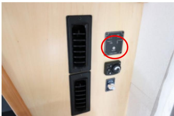
コンセント、テレビ使用時インバーターのスイッチを入れてください。サブバッテリーから電気をとっているため炊飯器、湯沸かしポットなど電力量の大きい機器は使えません。携帯の充電などにご利用ください。
