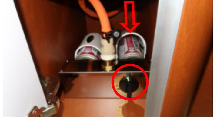
カートリッジのカバーをしっかりとセットし、レバーを回して元栓を開けます
