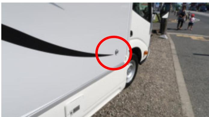
車内にある電源コードを使います。外部から電源をとれば車内で家電製品が使えます。
