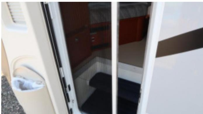
網戸を閉めたままドアを閉めると網戸が壊れるので必ず網戸は開けてからドアを閉めて下さい
