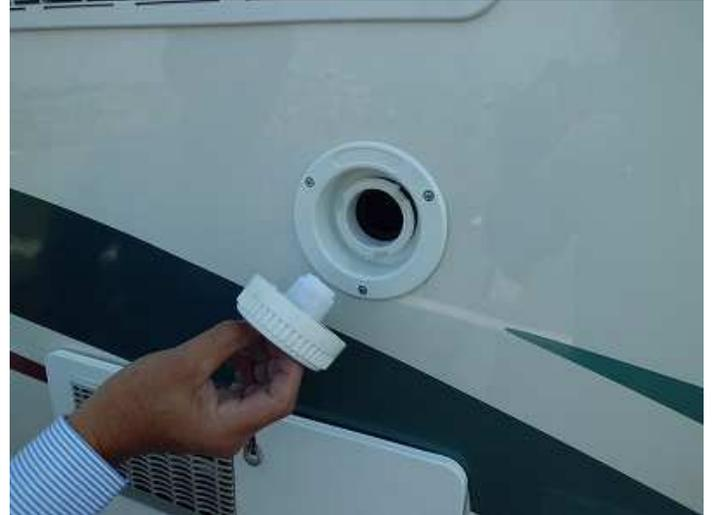
生活用水の給水口。運転席側にあります。鍵を開けてキャップを回します。貸出時は水が入っていますが、なくなったら補給してください。
