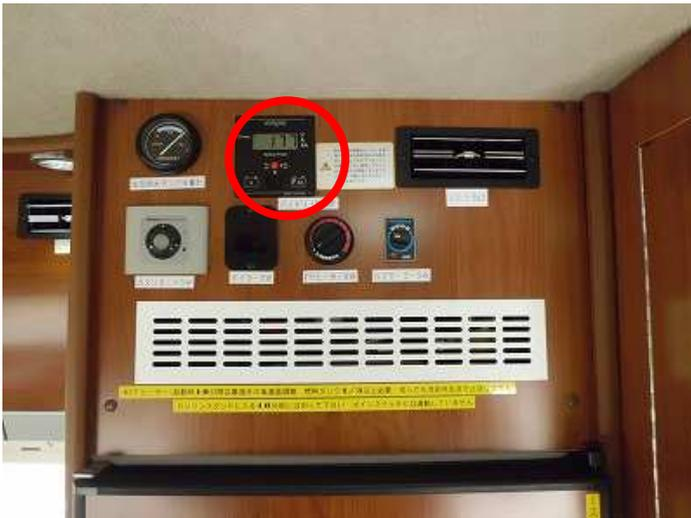
サブバッテリーの残量計。サブバッテリーの残量と現在の使用電力が表示されます。
