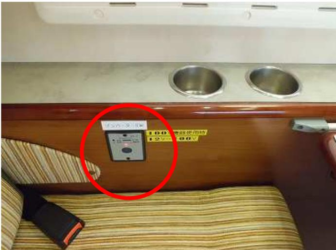
インバータースイッチ。12V サブバッテリーの電気を100V に変換します。エアコン、テレビ、コンセントを
