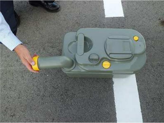
キャップを開けて汚水を排出します。洗浄液により水状態になっています。大便器に排出するといいです。
