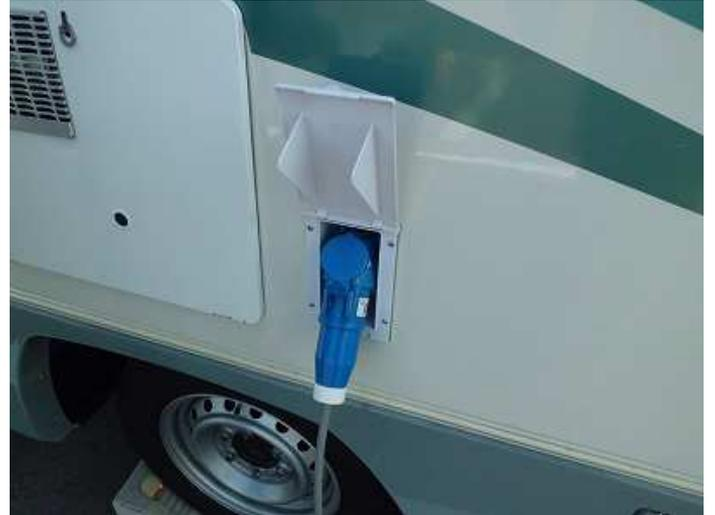
外部電源差込口。運転席側にあります。車内にある専用のコードを使い、電源から電気をとります。
