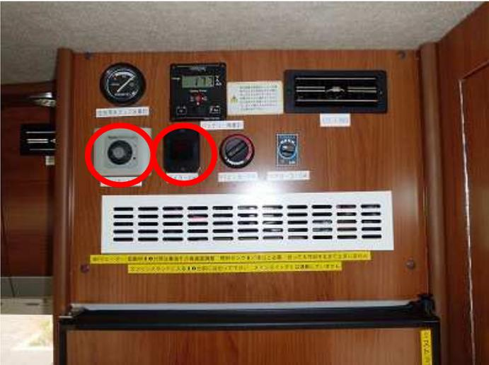
ガスボンベの元栓を開けます。左のガスリモートスイッチを入れます。右のボイラースイッチを入れます。水道の蛇口を温水にしてしばらく出すと温水になります。走行中はエンジンの熱によって温水が出てきます。温水は生活用水なので飲めません。
