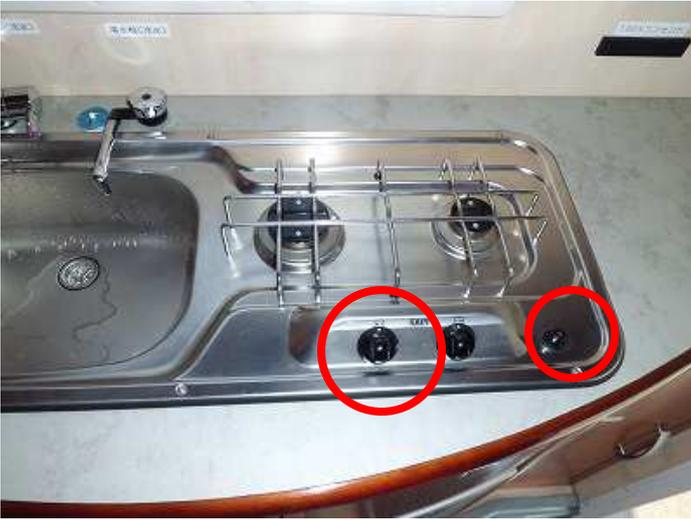
左の火力調節レバーを最大にして、右の点火スイッチで着火します。火がついて安定したら火力を調節します。一度で着火しない場合は何回か点火してください。
