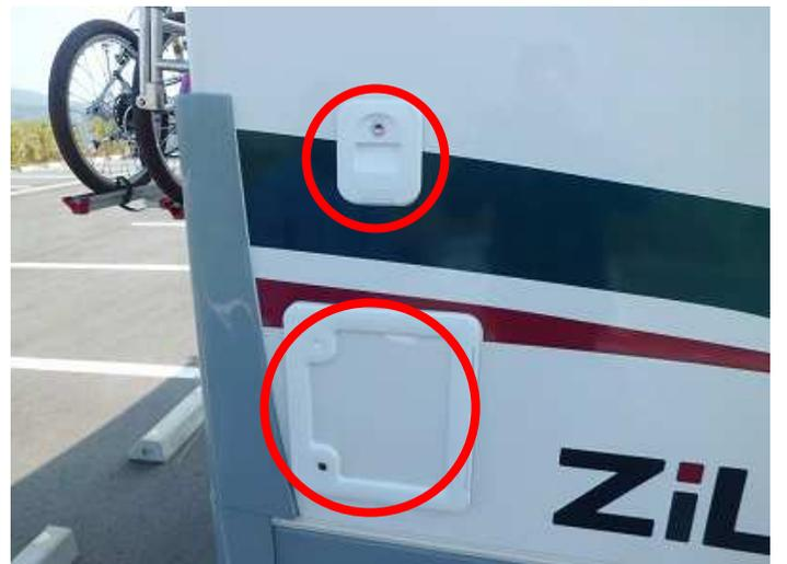
上が洗浄水の給水口。下が汚水カセット取り出し口。鍵がかかっているので開けます。
