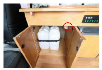
白いカバーを開いてカートリッジを交換します。 ガスカートリッジにガス元栓があります。
