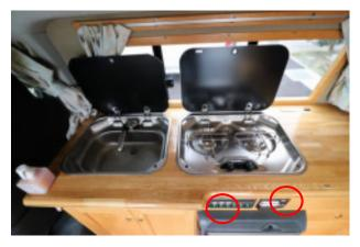
メインスイッチ、水道ポンプスイッチ ON 給水タンクに水を入れて使います。タンクが空の 状態で水道ポンプのスイッチを入れると水道ポ ンプのモーターが焼き付いて故障します。
