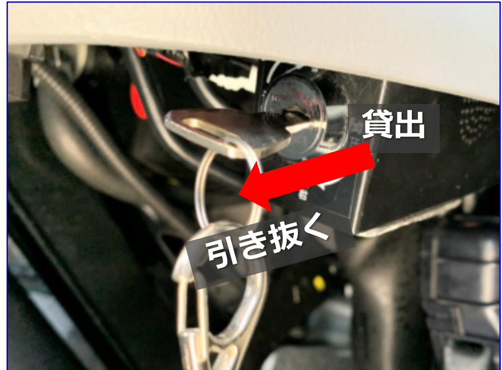
システムキーが横向きに止まったら手前に引出して貸出し完了です。
