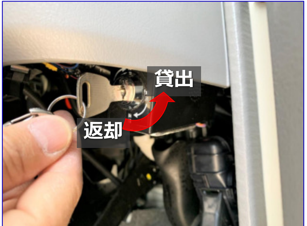
システムに刺さっているキーを反時計回りに横向きに回します
