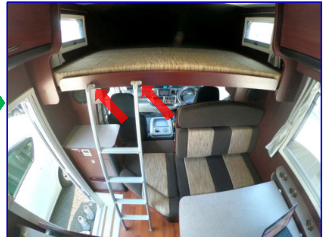
昇降用ラダーを掛けて完成！
