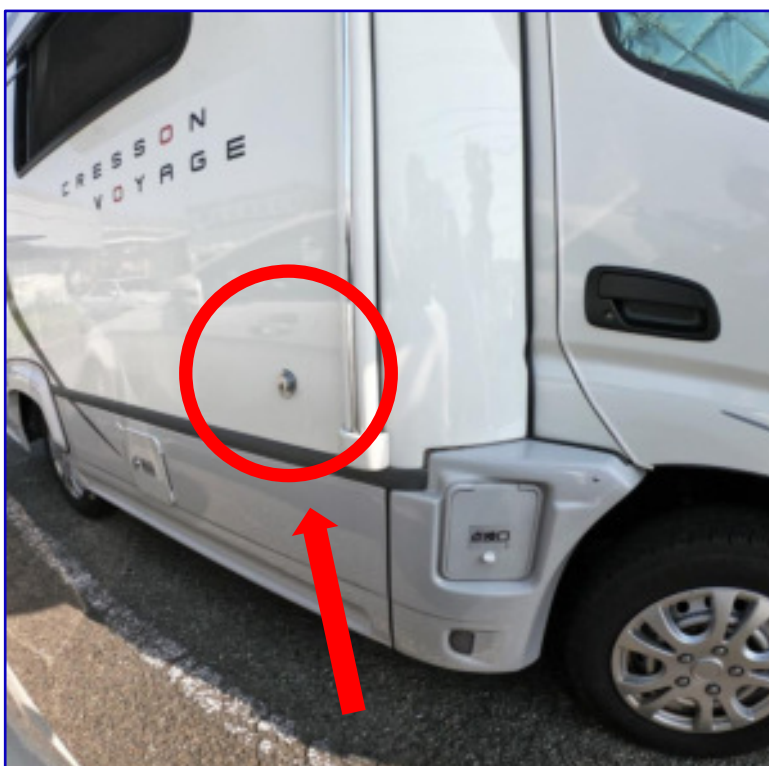
外部電源ケーブル差入口
