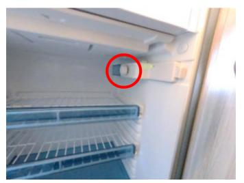
温度調節ダイヤル。電気を消費するので使わない場合は OFF にしてください。
