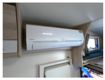
外部電源接続で稼働。インバーターでは数時間稼働。 走行中も使えます。
