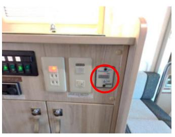
コンセントを使うときに ON。インバーターはサブバッテリーの 12V を家庭用 100V に変換する機器です。炊飯器、ホットプレートなど容量の多い機器は使えません。
