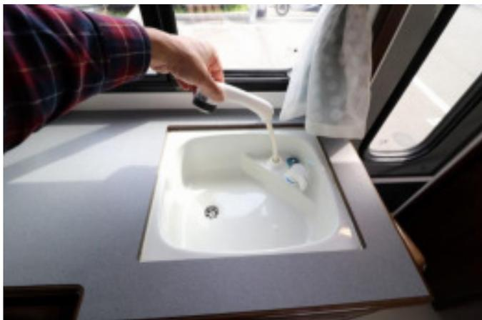
集中スイッチの水道ポンプ ON、蛇口を伸ばせばシャワーになります。給水タンクに水を入れてください
