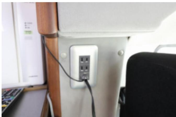
外部電源使用時、またはインバーターで使えます。インバーターでは炊飯器やホットプレートなど電気を多く使う機器は使用できません。外部電源をご利用ください。
