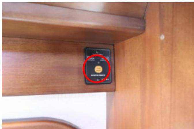
ボタンを長押ししてON。インバーターはサブバッテリーの12Vを100Vに変換する機器です。コンセント使用時に使います。
