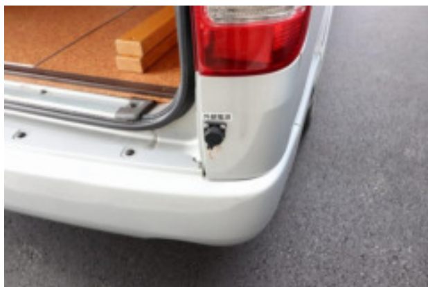
外部電源接続口
