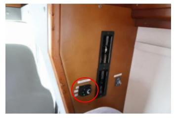
左上のボタンを押して5分ほどすると温風が出てきます。真ん中のボタンを押して消します。ボタンを押してもしばらくは温風出てきます。
