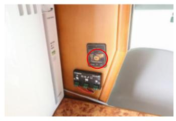
インバーターはサブバッテリーの電気を 12V から 100V に変える機器です。
