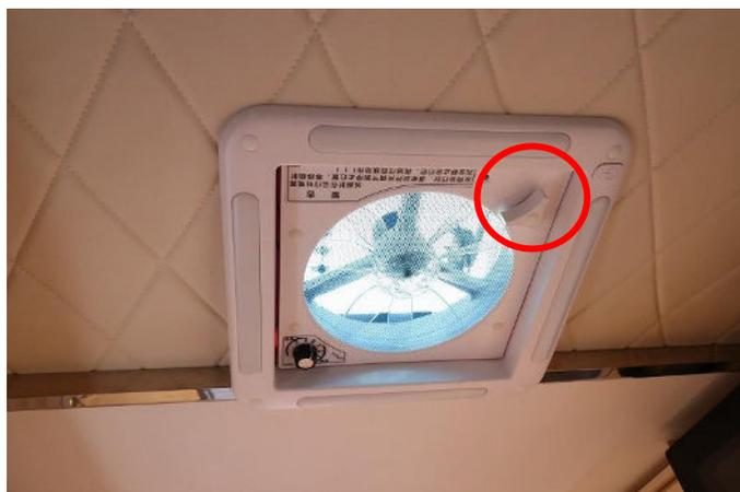
ノブを回して排気口を開きます。スイッチパネルの換気扇を ON
