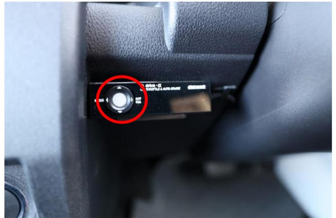
ボタンを押して速度セット。上矢印で速度 UP。下矢
